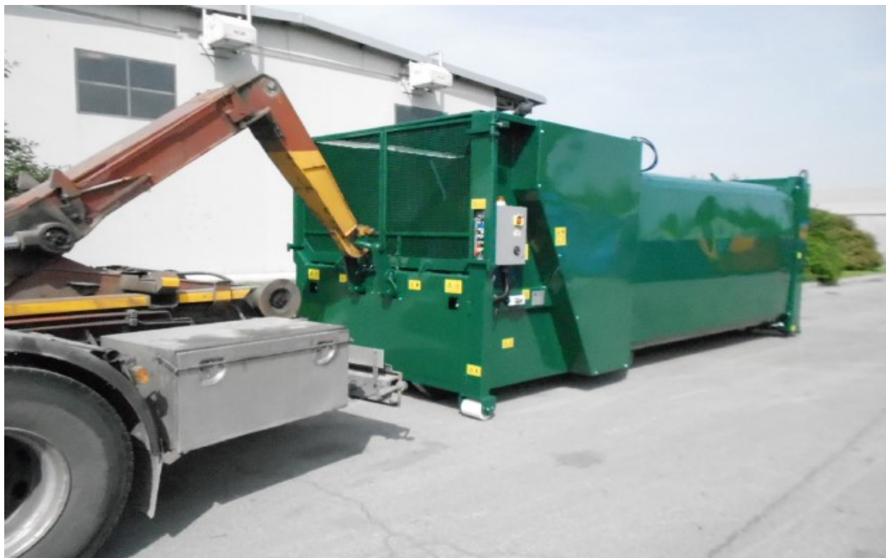
Movimentazione con veicolo scarrabile
