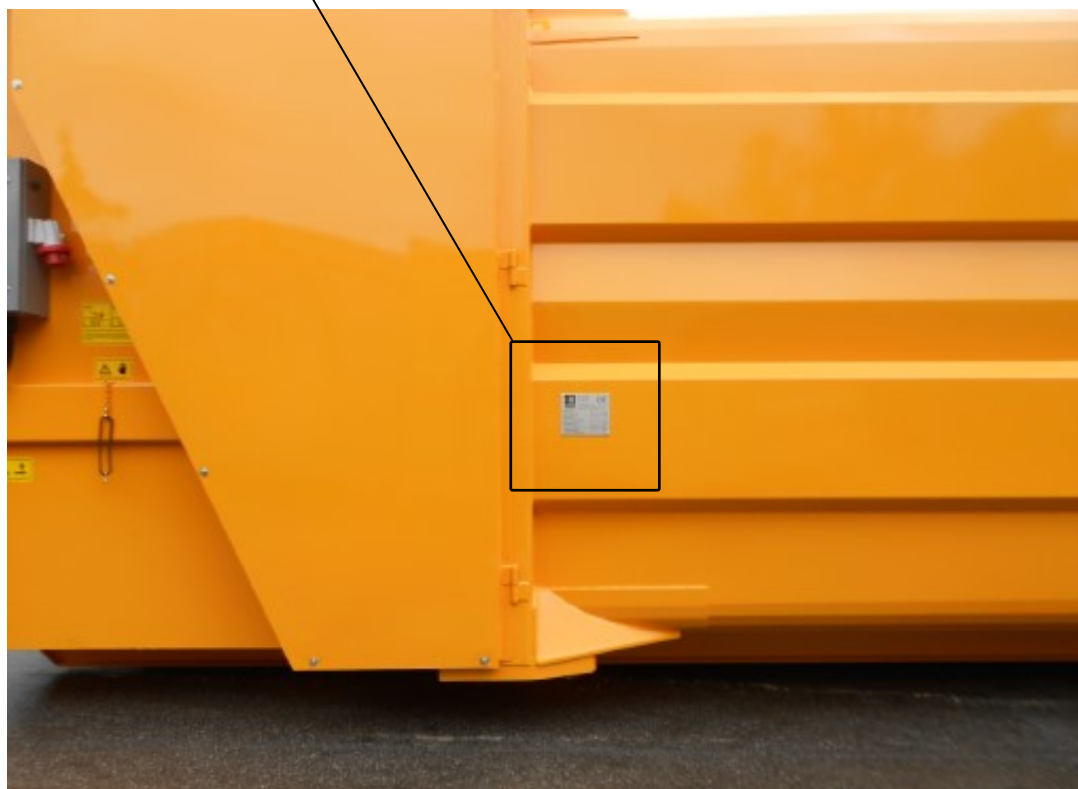
Posizione della targhetta di identificazione
