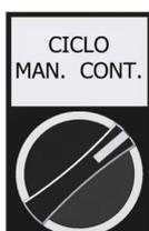
Le modalità di utilizzo sono identiche al ciclo continuo sopra descritto ma l'avvio della macchina avviene in modo completamente automatico, in presenza di materiale all'interno della tramoggia di carico e si arresta automaticamente in assenza di materiale.
